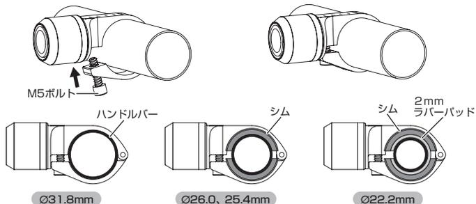
※その他のハンドルバー径への取り付けは、1mm、2mmラバーパッドで調節してください。
