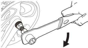
左クランクは逆ネジになっているため時計方向に回すと締まり、反時計方向に回すと緩みます。左クランクを取り外す際はご注意ください。
