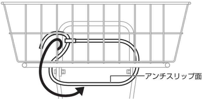
図のようにストラップを取り付け、バスケットや荷物をキャリアーにしっかりと固定してください。
