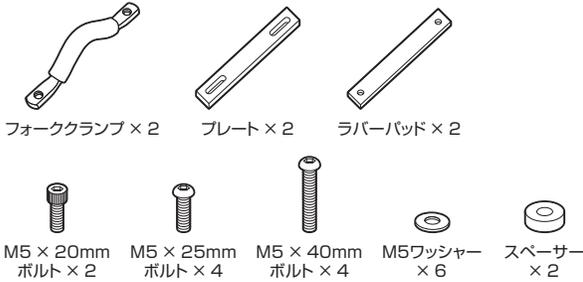
取付方法を確認し、以下の手順に従ってキャリアを取り付けてください。
