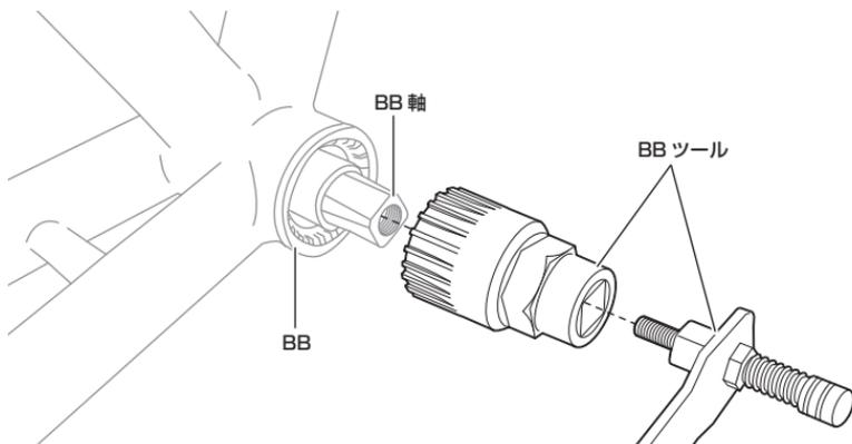
②BB軸固定ねじを押し込みながら時計方向に回して、BB軸のネジ穴にねじ込み、固定します。
